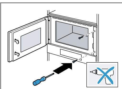
5. Predvŕtajte otvory pre skrutkové spojenie na nábytku na strane závesov.
