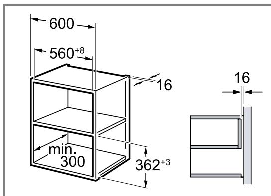
Urządzenie należy zamontować na takiej wysokości, aby możliwe było swobodne wyjmowanie wyposażenia. Usunąć nóżki.
